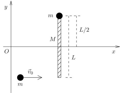
a) [0,5 pt.] Determine o momento de inércia  $I_{CM}$  do conjunto de corpos, depois do choque, em relação a um eixo na direção  $\hat{z}$ , passando pelo centro de massa.
